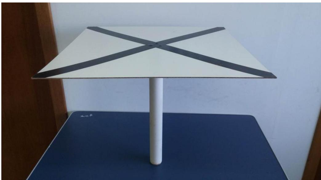
**Figura 2. Marcador GCP utilizado em campo**
