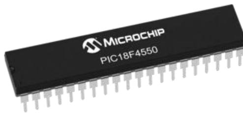
**Figura 1 – Microcontrolador PIC18F4550 (Fonte: Microchip, 2016)**
