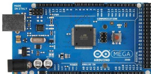
Figura 1 – Microcontrolador Arduino Mega 2560 R3 – Fonte: Arduino, 2016
